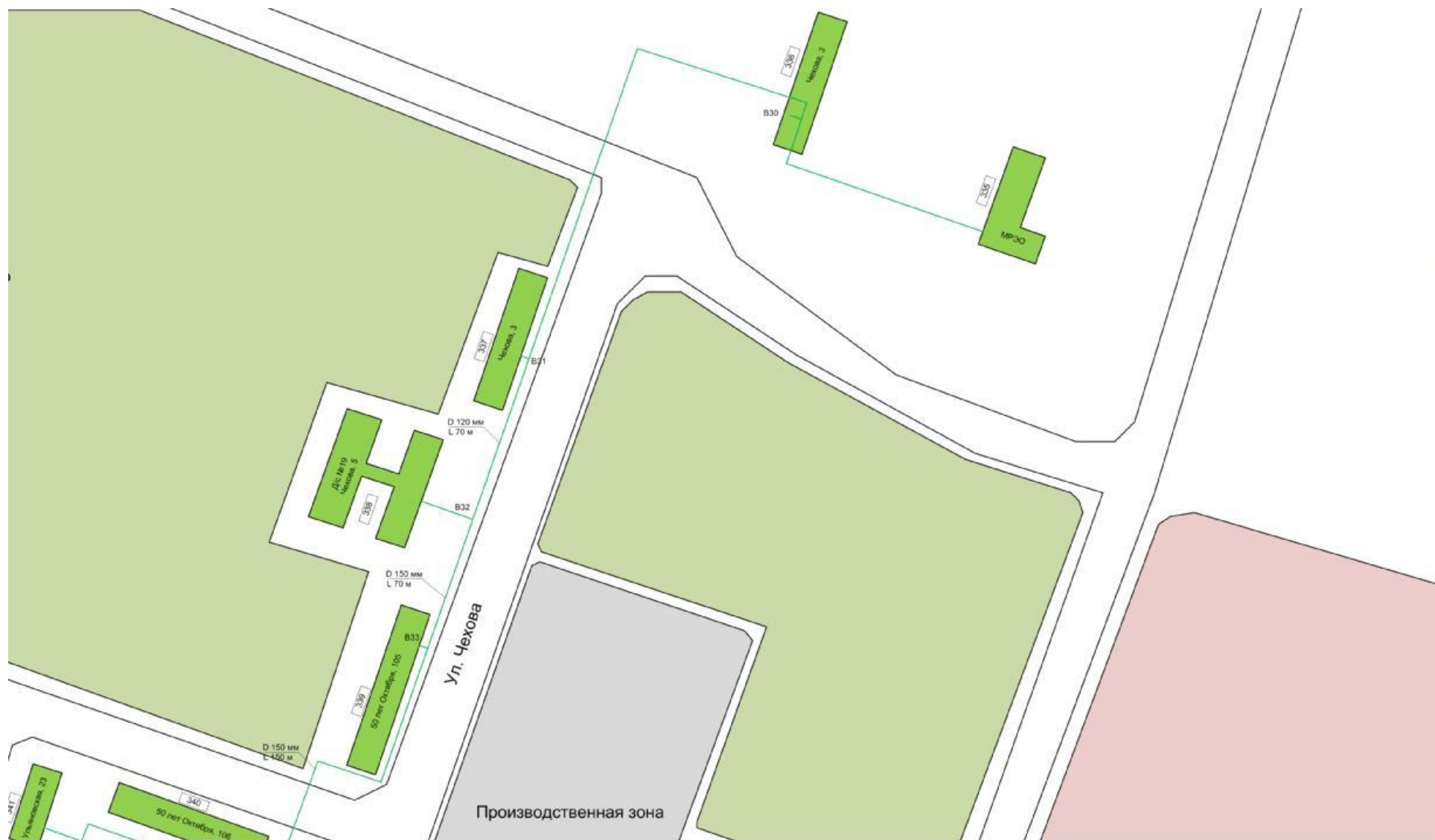
Рисунок 1.3.2.8 - Схема тепловых сетей котельной №3 г. Кинель
