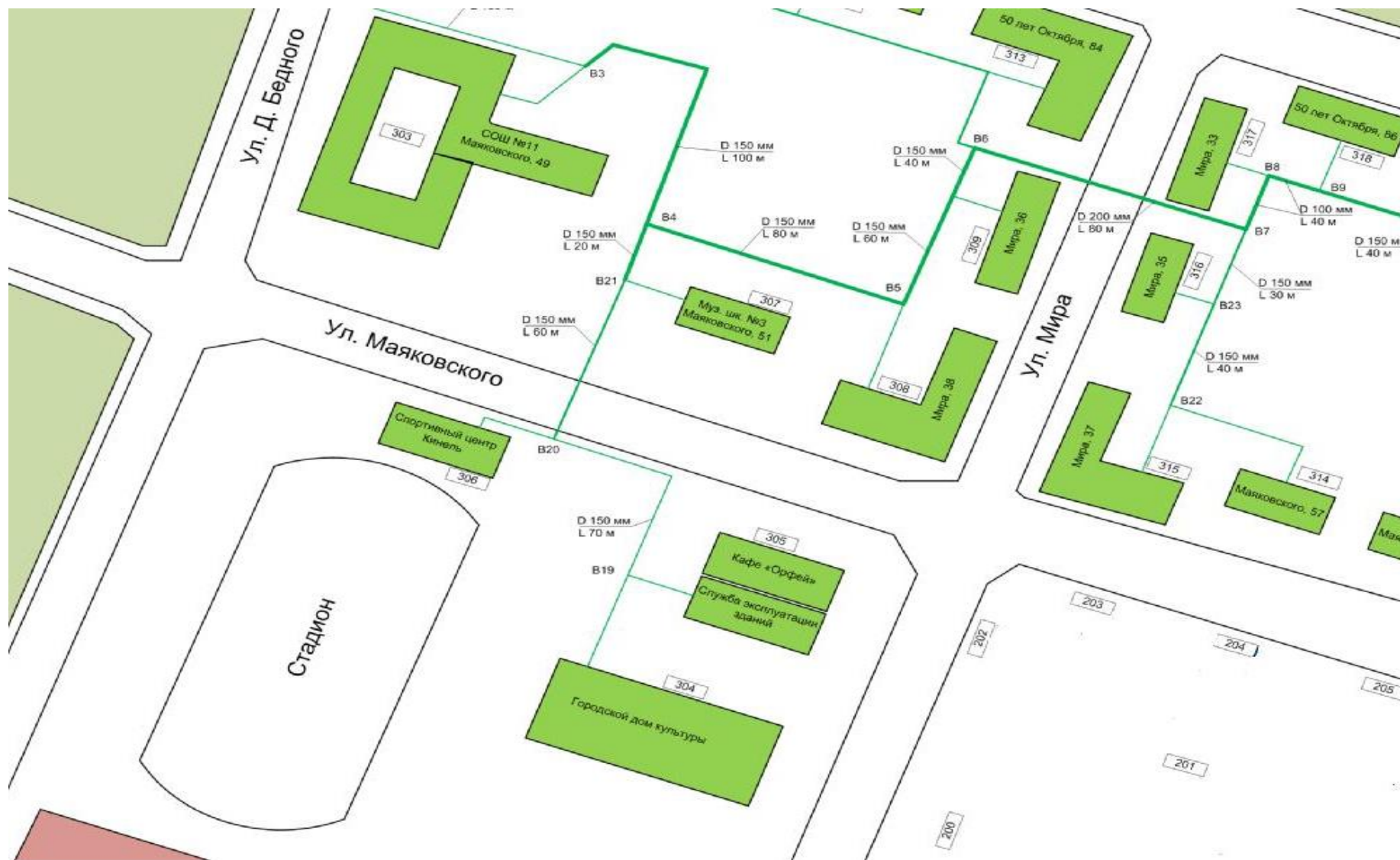
Рисунок 1.3.2.4 - Схема тепловых сетей котельной №3 г. Кинель
