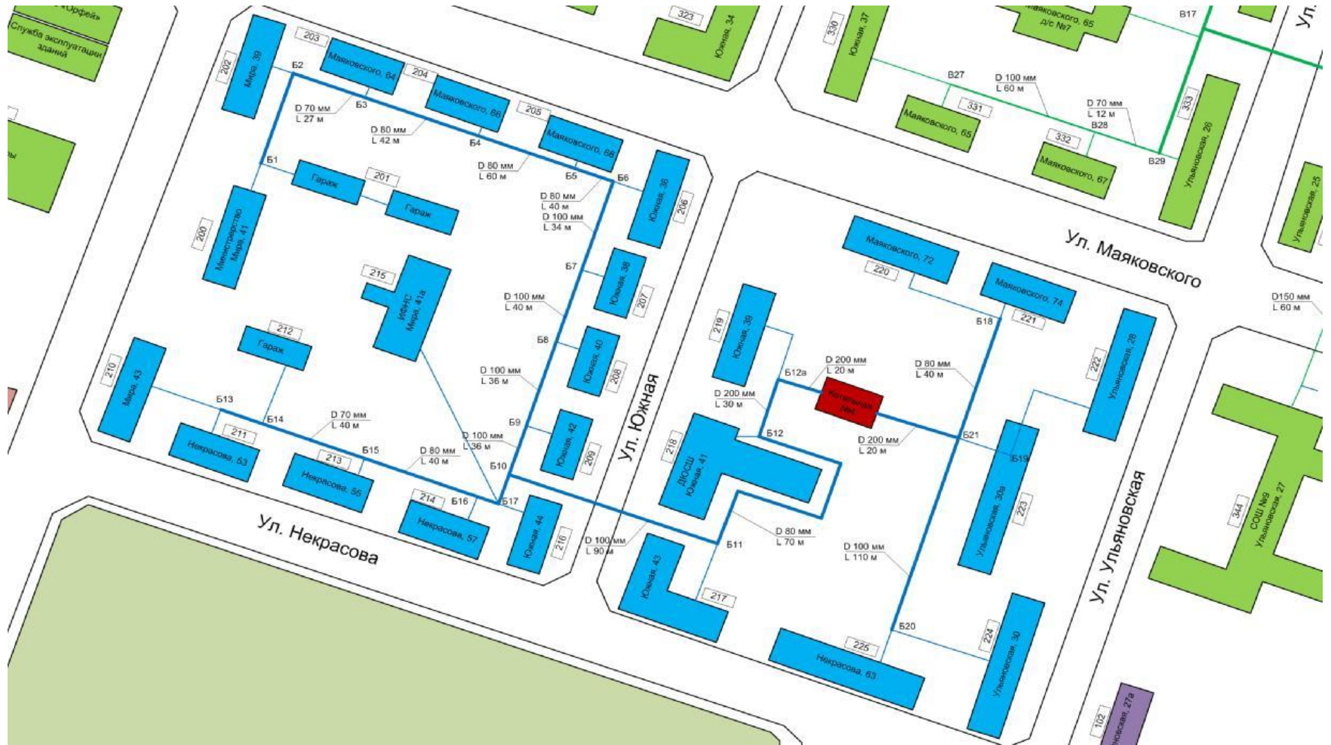
Рисунок 1.3.2.10 - Схема тепловых сетей котельной №12 г. Кинель
